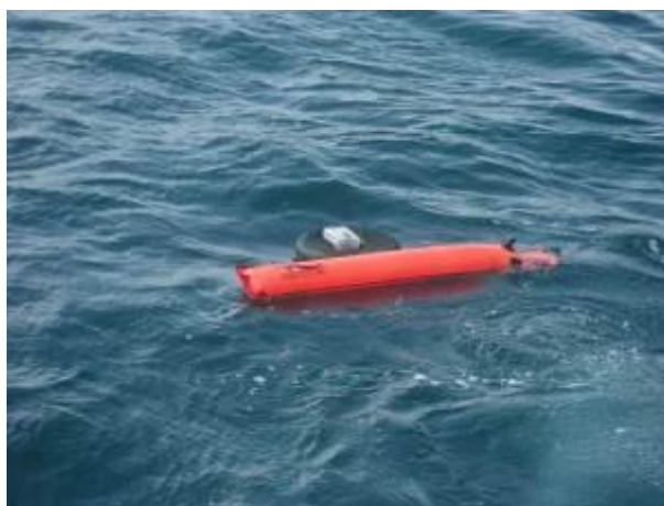
Figure 14 - GPS portable dans une boîte étanche fixée à une chambre à air gonflée et tractée à côté d'une bouée de plongée
