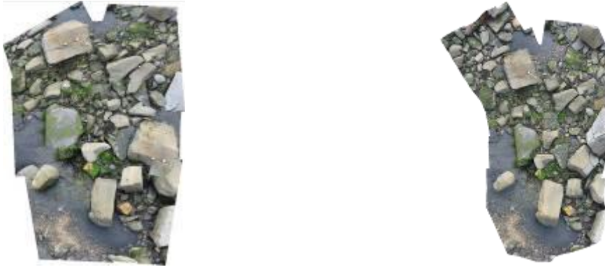
Figure 8 – Mosaïque de 10 images d'une scène accidentée. L'image de gauche a été créée à l'aide de l'outil Photomerge de Photoshop, qui ne gère pas les modifications de parallaxe. L'image de droite est ortho-rectifiée et a été réalisée à l'aide de PhotoScan
